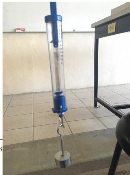
Figura 2: Dinamometro con dos pesas.
