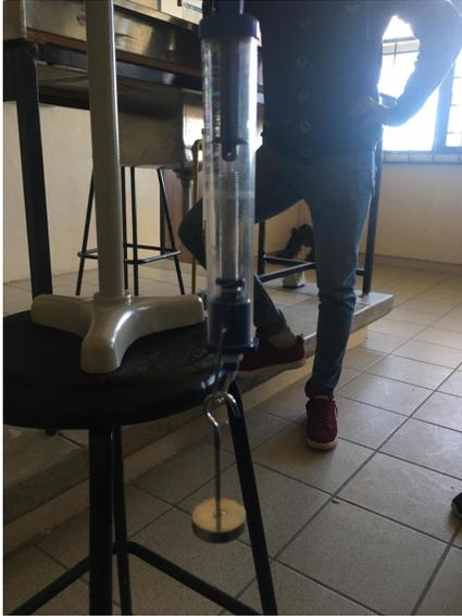
Figura 3: Dinamometro con una pesa
