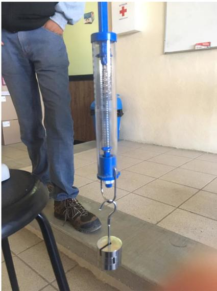
Figura 4: Dinamometro con masa resultante parte A.
