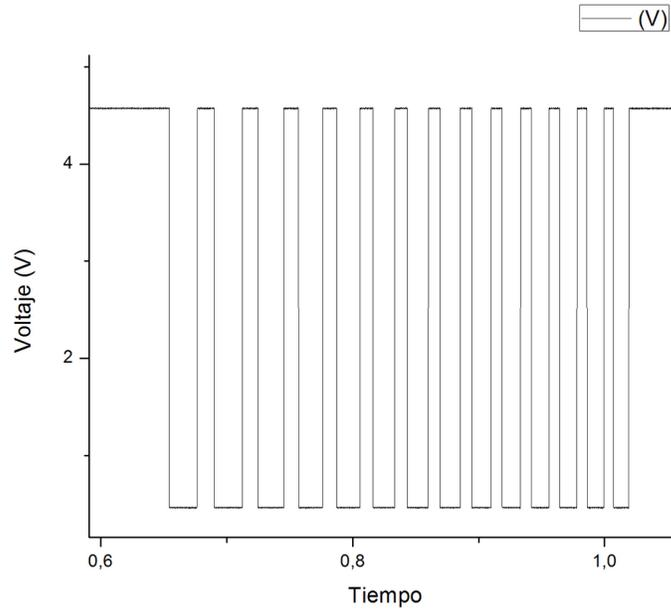
Figura 3: Gráfico obtenido con el Sensor DAQ, con la diferencia entre dos valles se obtiene el período(T).
