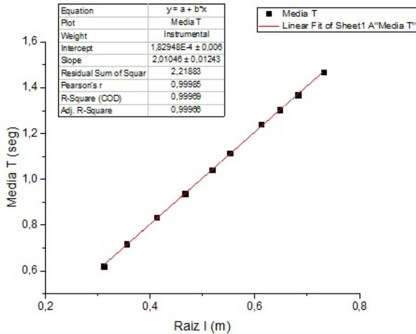
Figura 4: Gráfico de la ecuación 9, media de T vs. raiz de la longitud l
