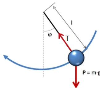
Figura 1: Péndulo simple, un instante después de soltarlo
