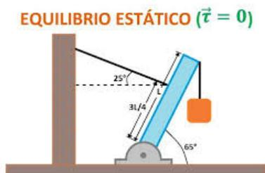
Figura 1. Representación esquemática del equilibrio estático [1]
