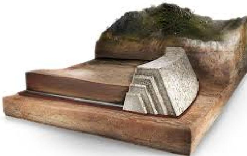
Figura 1: representacion esquematica de una presa de jales obtenida de este [sitio web](#)
