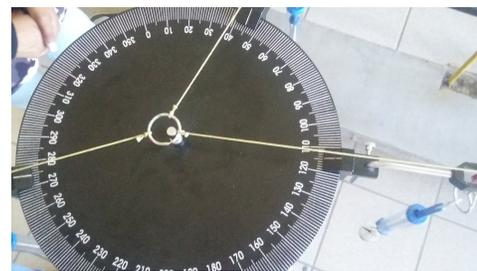
Figura 2. En esta figura se muestra la mesa de fuerza con el anillo y las fuerzas.
