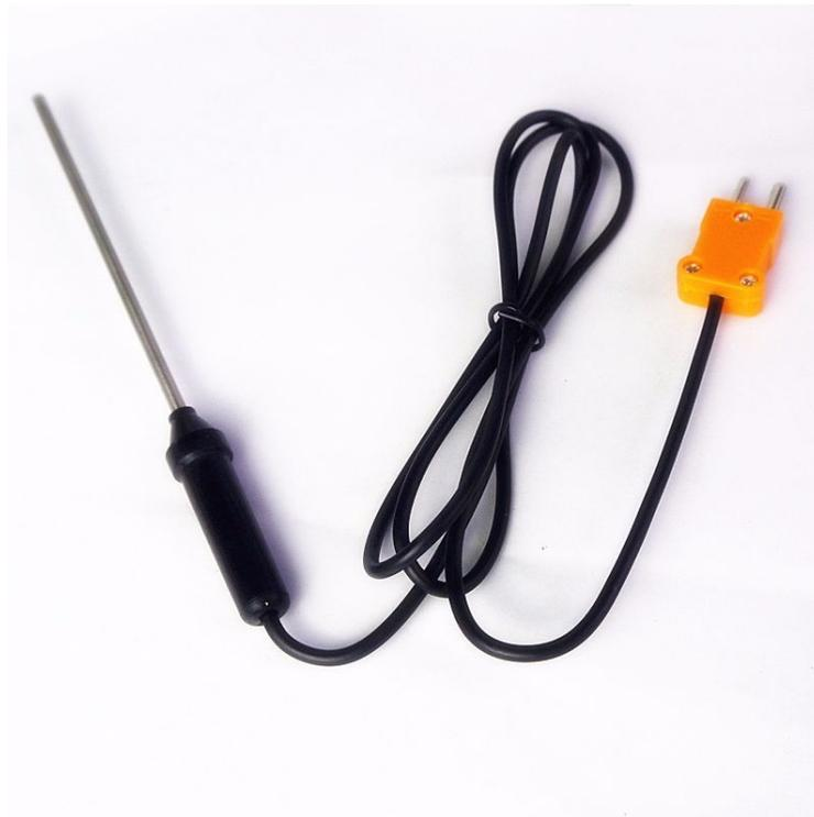
Figura 10: Termopar tipo K
