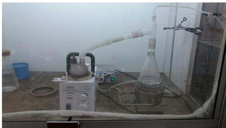
Figura 5: Sistema de rocío pirólítico en el IER-UNAM
